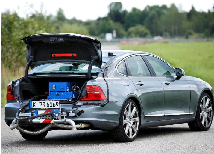
Abbildung 6: Testfahrzeug mit eingebauter PEMS-Messanlage
